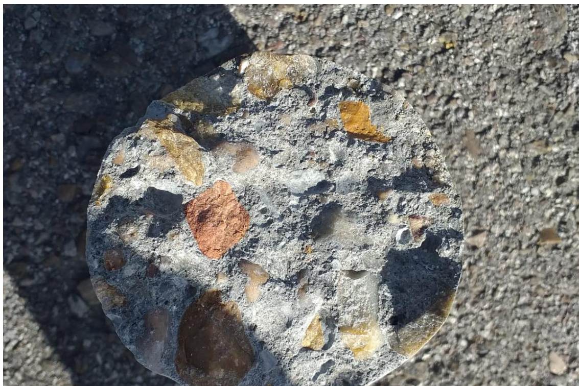
Figura 2-61 Sección testigo de investigación árido-álcali.
